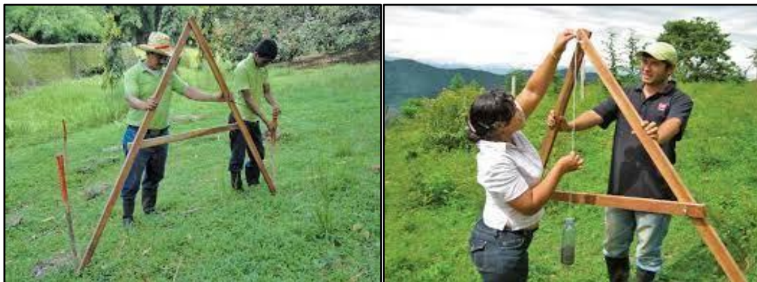
Figura 5.13. Exemplos de marcação de curva de nível com utilização de pé-de-galinha.
